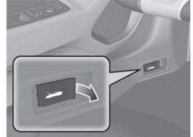
2. Repérez la détente d'ouverture du capot, poussez la détente et soulevez le capot.
